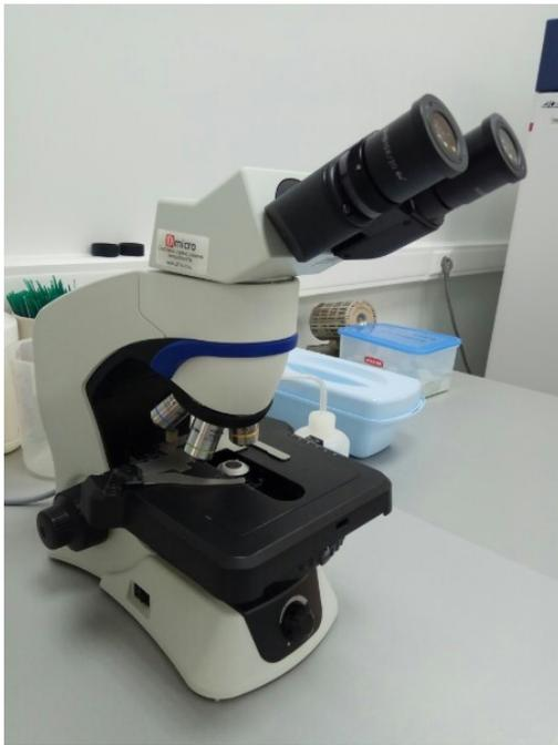
Рисунок 6. Микроскоп с конденсором темного поля.
