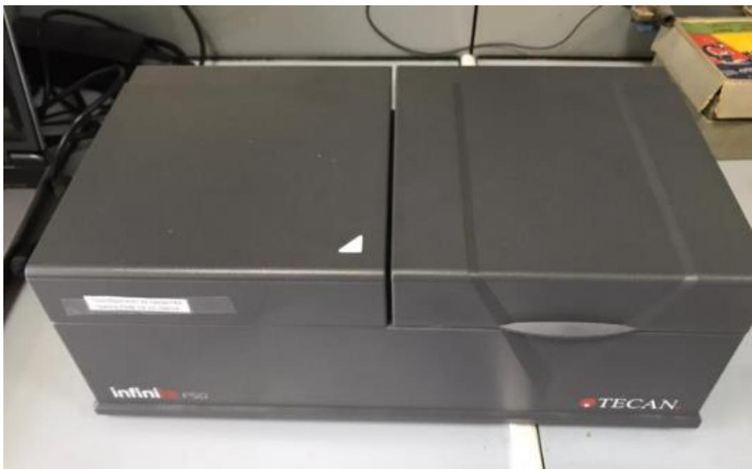
Рисунок 21 - Имуноферментный ридер «INFINITE F50», TECAN
