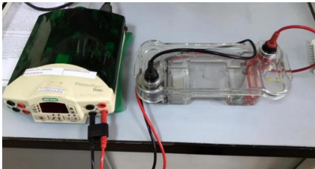
Рисунок 20 - Камера для горизонтального электрофореза фирмы «BioRad»
