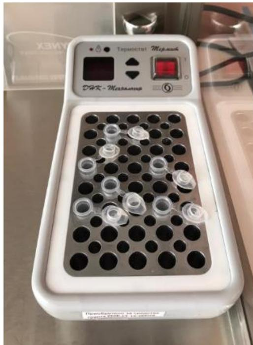
Рисунок 18 - Термостат для пробирок типа «Эппендорф» «ДНК - Технология», Термит
