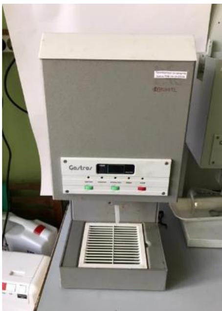
Рисунок 14 - Гельминтологический аппараты для выделения личинок трихинелл методом переваривания мышечной ткани в искусственном желудочном соке типа «Гастрос», ПЕТРОЛАЗЕР
