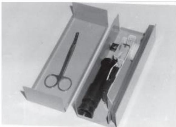
Рисунок 22 – Устройство для полевой трихинеллоскопии ТП-2
